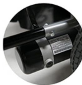
Motor com tração por redutor e freio eletromagnético
