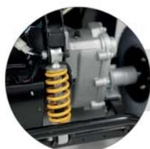
Sistema de suspensão individual com molas helicoidais e monolink
