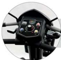
Painel com indicador de nível de bateria, controle de velocidade, buzina, farol e pisca-alerta
